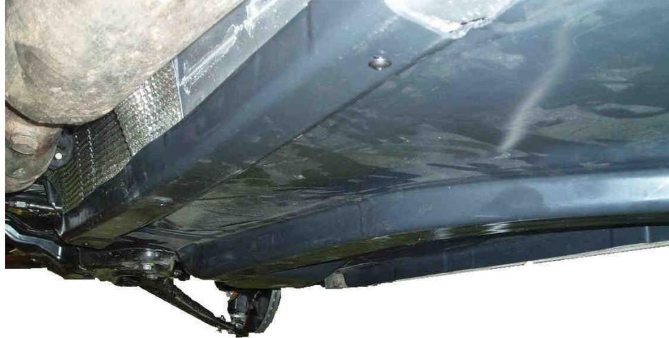
**Finalisation de l'assemblage** : Certaines zones des protections peuvent légèrement « bailler » entre la caisse. Combler ces espaces par de la mousse, et étancher par un cordon de joint silicone.
